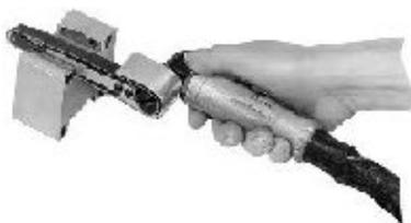
Kompletter Bandschleifer (Kombination aus Winkelschleifer 12S1280-36 und Bandschleifvorsatz 14-1316, siehe Seite 19) bei der Nacharbeit eines Werkstückes.
