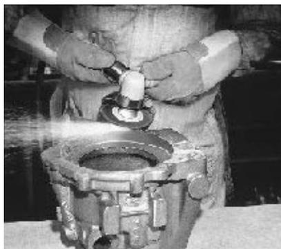
Modell 12S2752-65 bei Schleifarbeiten mit geköpfter Schruppscheibe Ø 115 mm.
