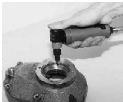
Modell 12S1200-36 beim Entgraten einer Bohrung mit einem kugelförmigen Hartmetall-Rotierfräser.
