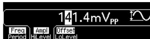
Wenn Sie die Amplitude in *Dekadenschritten* ändern möchten, setzen Sie den Cursor durch Drücken der rechten Pfeiltaste auf die Maßeinheit-Anzeige. Stellen Sie dann mit dem Drehknopf die Amplitude in Dekadenschritten auf den gewünschten Wert ein.
