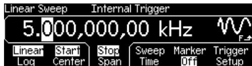
Der Funktionsgenerator gibt jetzt ein kontinuierlich von 50 Hz bis 5 kHz gewobbeltes Signal aus (sofern der Ausgang aktiv ist).
