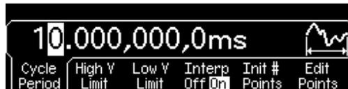
**4 Spezifizieren Sie die Spannungsgrenzen für das Signal.**
