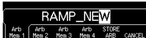
Das Signal ist jetzt im nichtflüchtigen Speicher gespeichert und wird ausgegeben. Der Name, unter dem das Signal abgespeichert wurde, wird in der Liste der gespeicherten Signale (die Sie mit dem Softkey **Stored Wform** abrufen können) angezeigt.
