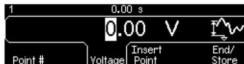
*Beachten Sie, dass der Arbiträrsignal-Editor alle Amplitudenberechnungen in der Einheit Vpp (und nicht etwa Vrms oder dBm) durchführt.*
