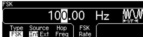
*Der Funktionsgenerator gibt jetzt ein FSK-moduliertes Signal aus (sofern der Ausgang aktiv ist).*
